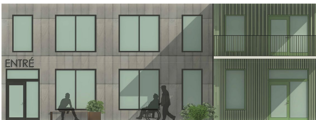
Figur 11: Exempel som visar ribbor 75x120 mm med 40 mm mellanrum i entréplan ribbor 75x170 med 125 mm mellanrum för plan 2
