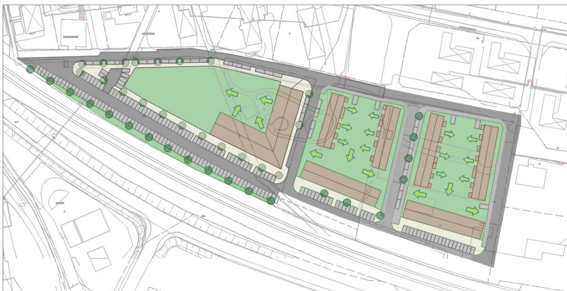
Figur 17. Innergårdar på området bör höjdsättas så att ytvrinning sker bort från husfasader.
