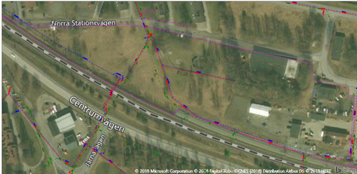
Figur 5. Schematisk bild av befintliga VA-ledningar där blå är vattenledning, röd spillvattenledning och grön dagvattenledning (modifierad bild från google.maps.se).
